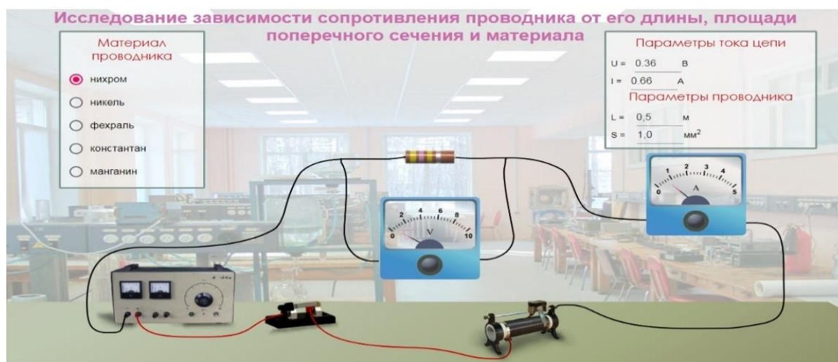
Рисунок 6. - Окно виртуальной экспериментальной работы «Изучение зависимости сопротивления проводника от длины, площади поперечного сечения и его материала»
